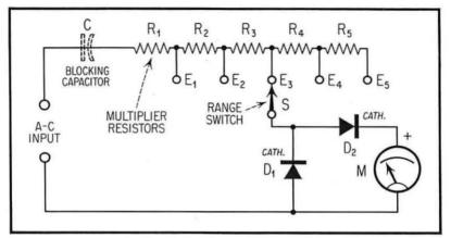
Fig. 5. Multi-Range Voltmeter.
