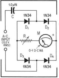
Fig. 6. Full-Wave Meter Rectifier Circuit.
