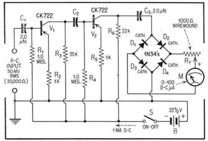
Fig. 8. Two-Stage Transistor-Diode Voltmeter.
