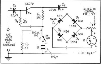
Fig. 7. Single-Stage Transistor-Diode Meter.
